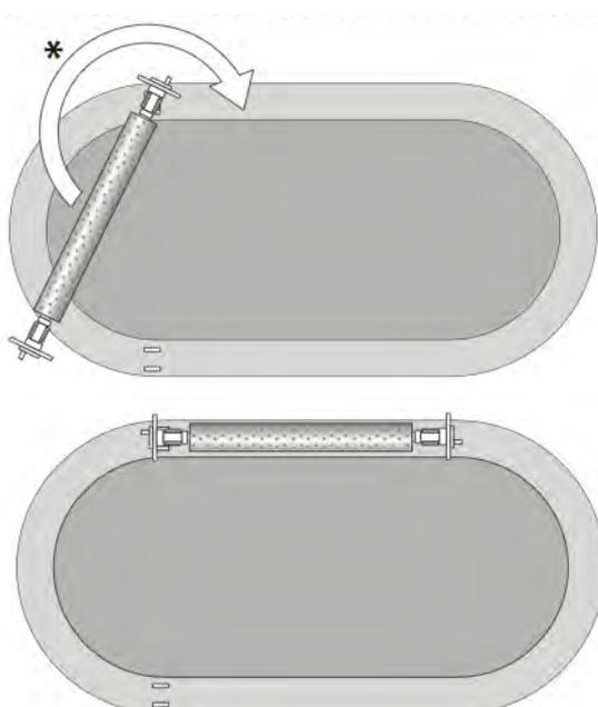
\* Qualora la piscina non avesse una lunghezza sufficiente per appoggiare l'avvolgitore sul bordo durante la balneazione, rimuovere completamente l'avvolgitore dalla piscina.
