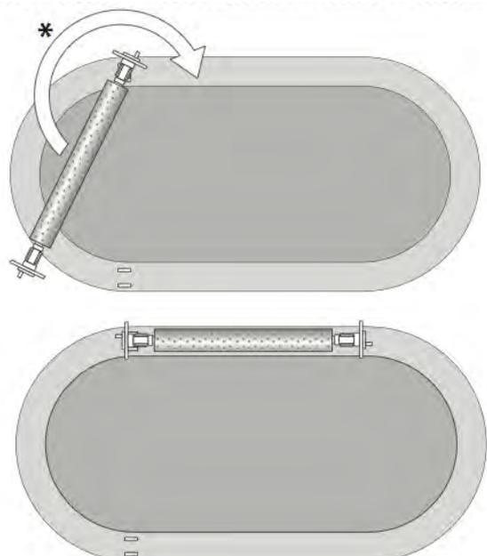
\* Falls das Becken nicht lang genug ist, um die Aufrollvorrichtung während der Poolnutzung am Rand abzusetzen, sollte sie vollständig vom Becken entfernt werden.
