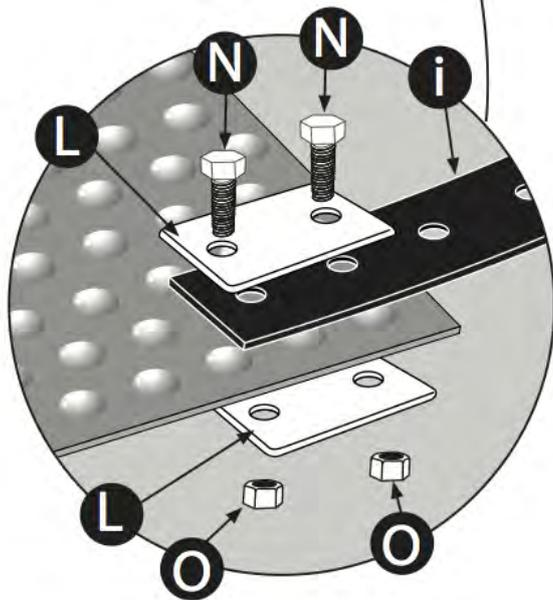
• Befestigung der Abdeckung an der Aufrollvorrichtung (rundes oder ovales Becken)
