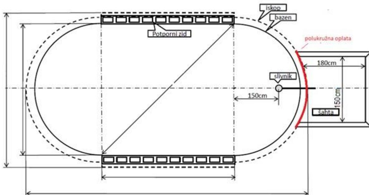
Prema mašinskoj šahti treba napraviti oplatu jer se ona NE BETONIRA, a cev od slivnika treba provući kroz oplatu i zaštititi.
