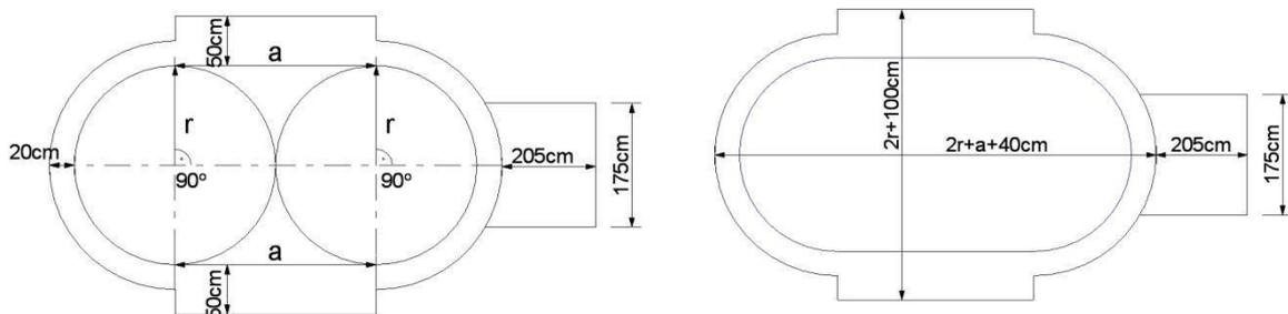
*Savet: Kako bi potporni zidovi bili idealno paralelni, u svim tačkama i jedan naspram drugog, kočiće spojite kanapom čime ćete dobiti osu bazena. Od te ose, pod uglom od 90° povucite liniju (r) prema kružnici, čime ćete dobiti tačan početak i kraj potpornog zida.*
