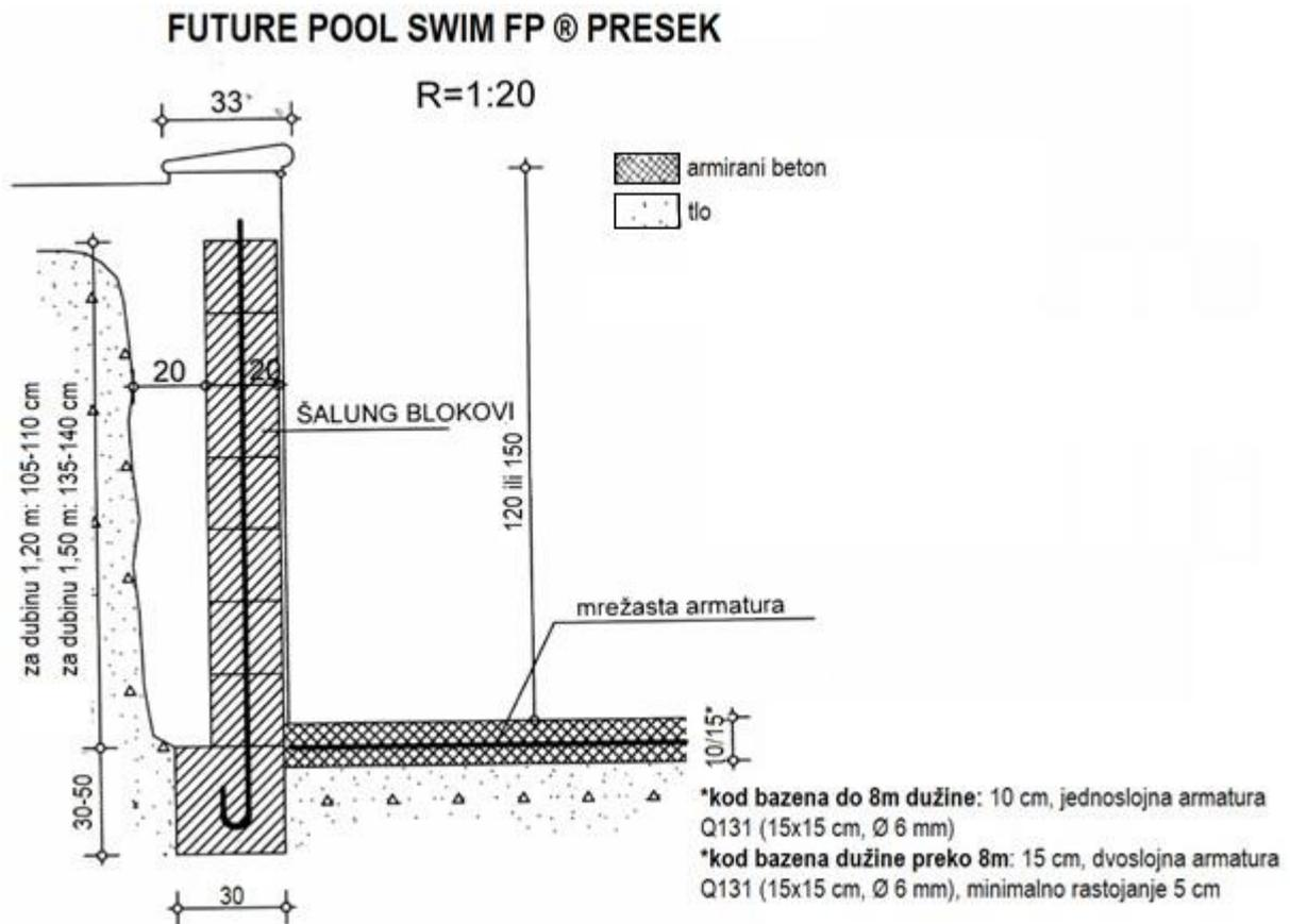
Potporni zidovi se grade od betonskih blokova, širine 20-25 cm, visine 19 cm i dužine 45-50 cm, sa jednom pegradom u sredini. Nakon izlivanja temelja i nakon što beton u temeljima malo „povuče“, postavlja se prvi red blokova.
